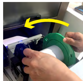
Étape 3. Tenez la bride et roulez-la comme indiqué par la flèche pour dérouler le papier coincé.*
