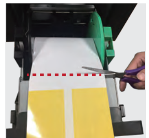
Étape 4. Étalez le papier jusqu'à ce que la partie coincée soit visible. Utilisez un ciseau pour couper la partie du bourrage papier.
