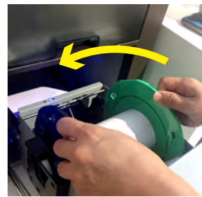
Schritt 3. Halten Sie den Flansch fest und rollen Sie ihn so, wie es der Pfeil anzeigt, um gestautes Papier auszurollen.*
