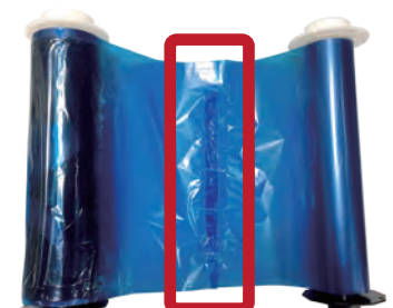
Kleben Sie das Farbband wieder zusammen, und legen Sie das Farbband wieder auf die Kassette (weitere Einzelheiten finden Sie im Abschnitt Farbbandinstallation).
